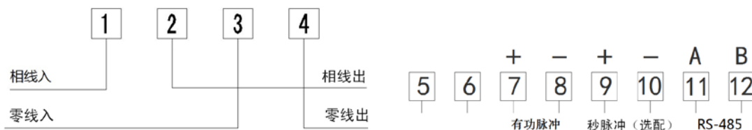
图 3 直接接入式接线图
